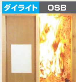
ダイライトは燃えにくい無機質素材 (火山性ガラス質材料と鉱物質繊維)
